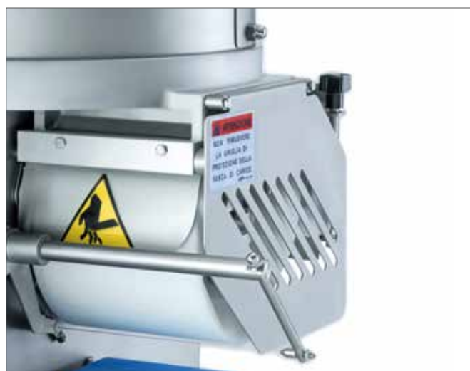
Formtrommel mit Edelstahl Draht zum Abtrennen der geformten Masse
